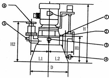
3 (圆) 型泵示意图 (防爆圆锥型)
