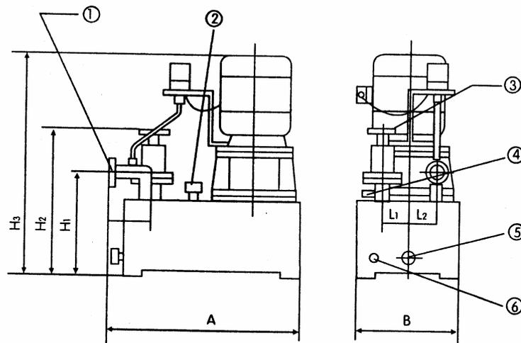
1型泵示意图（长方形）
