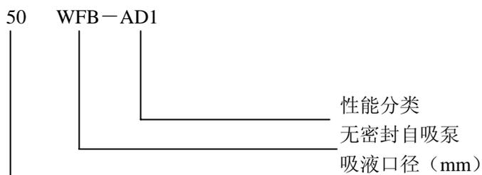
(3) 完整的型号书写方式。假设水泵的要求是：造型为推车移动型，材质为增强聚丙烯，吸入口径为 50mm,性能分类为 AD1。这台水泵的完整型号为“5PP50WFB-AD1”。
