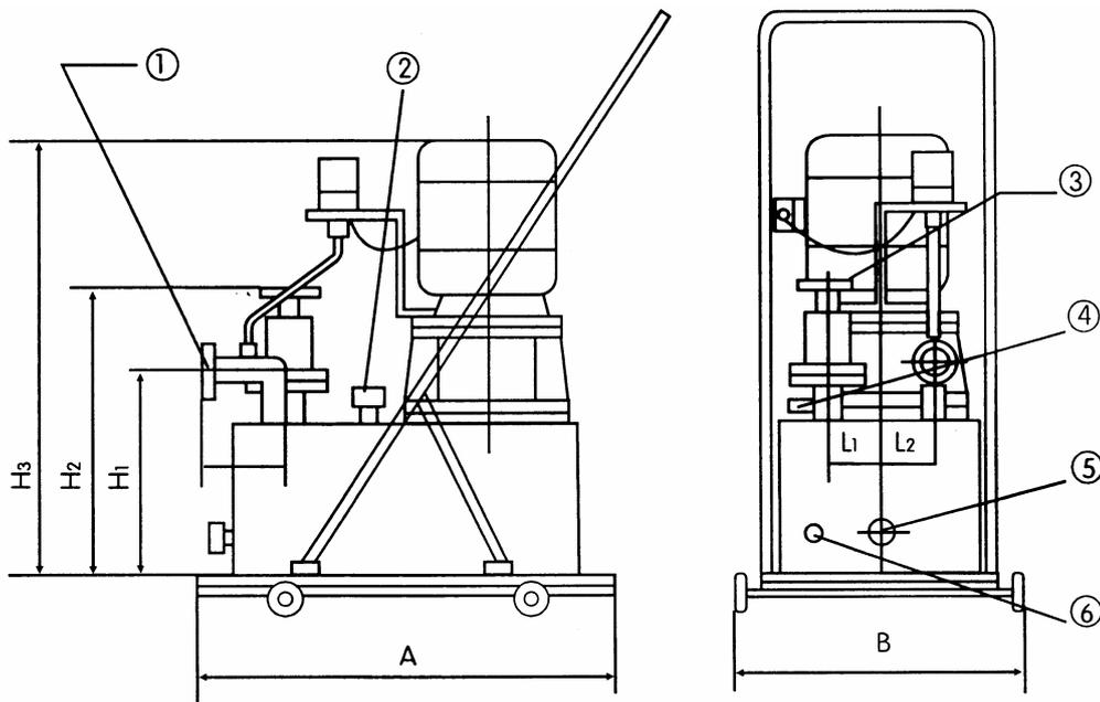
5型泵示意图（推车移动型）
